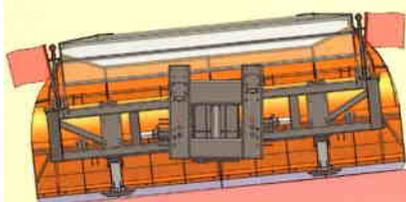
Durch seinen Ausgleich-Pendel-Mechanismus passt sich der Schneepflug optimal dem Bodenprofil an.
