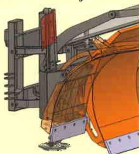
Dank speziellen Führungsbahnen weichen die Scharteile beim Überfahren von Bodenhindernissen bis zu 20 cm unbeschadet nach hinten und oben aus.
