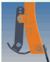
Gleitkufe abgenutzt - unterstes Loch
